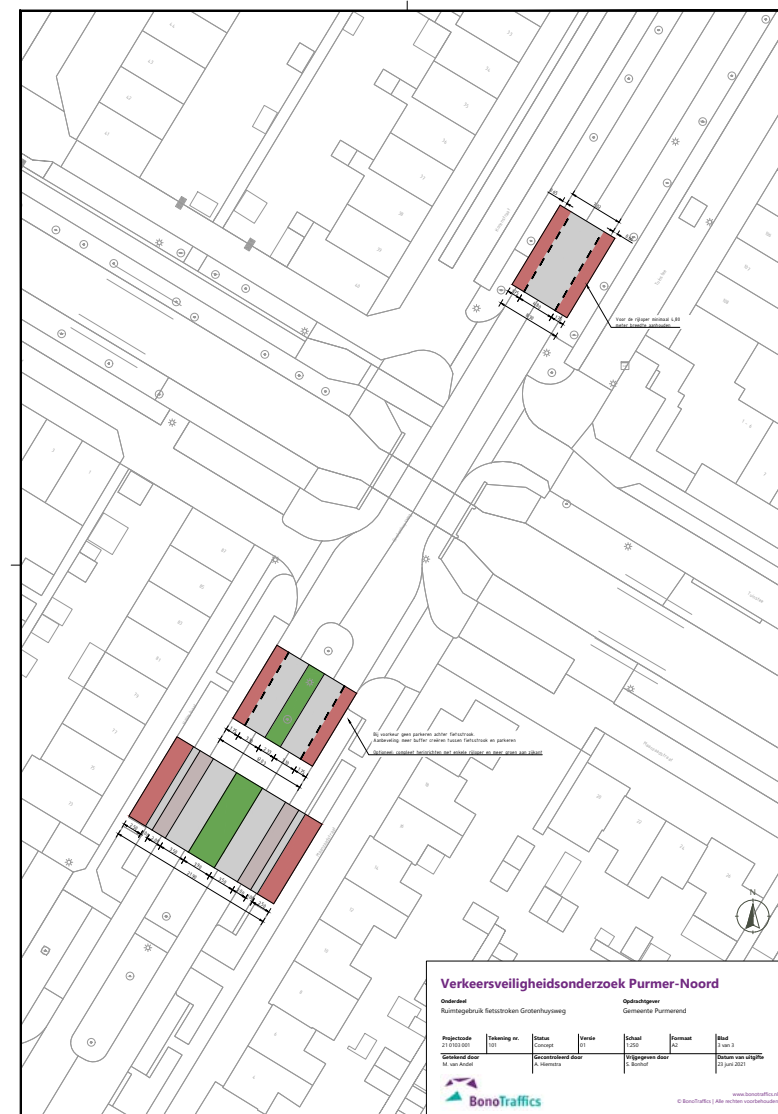
Afbeelding 20: dwarsprofielen fietsers op de rijbaan
